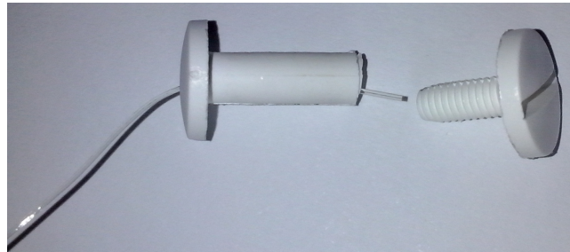
Figuur 6. Bevestigen van de korte TPU draad aan de houder schroef.
