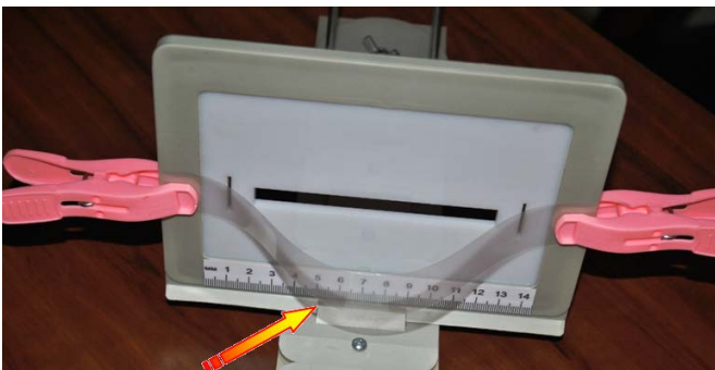
Fig. 1B Meetopstelling voor het waarnemen van dubbelbreking in de meetlat (liniaal).
