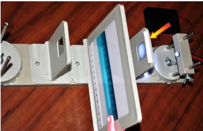
Fig. 1B Meetopstelling voor het waarnemen van dubbelbreking in de meetlat (liniaal).
