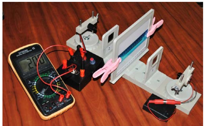
Fig. 4B Opstelling voor het meten van de transmissie van licht door de plastic meetlat (liniaal).
