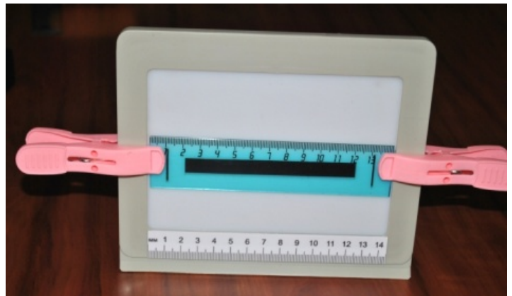
Fig. 2B Meetlat (liniaal) gemonteerd op het scherm.
