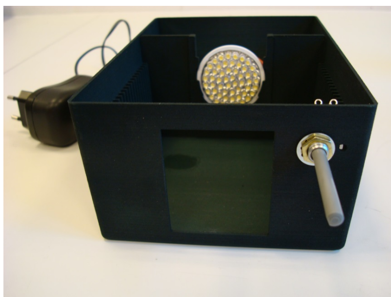
Figuur 2.2 (a) Doos met lichtbron en regelbare weerstand. (b) De weerstand gemonteerd in de doos. Het kleine pinnetje op de regelbare weerstand past in het gaatje rechts naast de as.
