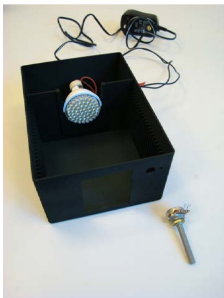
Figuur 2.2 (a) Doos met lichtbron en regelbare weerstand. (b) De weerstand gemonteerd in de doos. Het kleine pinnetje op de regelbare weerstand past in het gaatje rechts naast de as.
