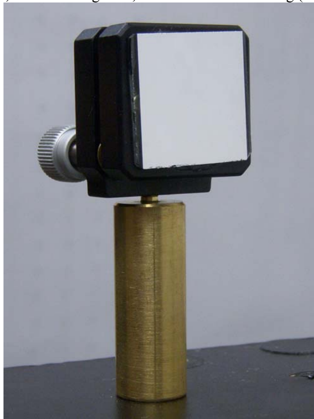
Beweegbare spiegel met twee afstelknoppen, gemonteerd op een verplaatsbare ondersteuningsvoet.
