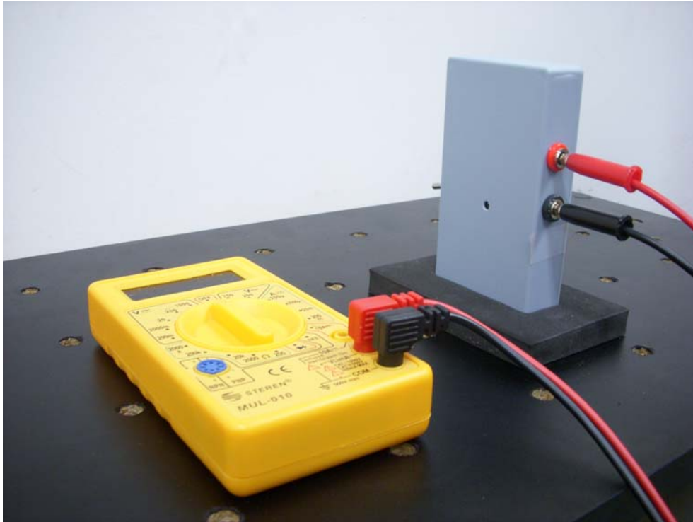
Fotodetector in plastic doos, aansluitingen en voet van foam. Een multimeter om de spanning van de fotodetector te meten (LABEL L). Sluit het aan zoals aangegeven.
